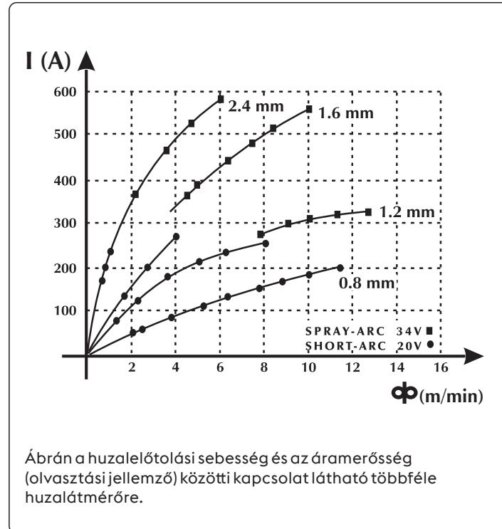
Ábrán a huzalelőtolási sebesség és az áramerősségek (olvasztási jellemző) közötti kapcsolat látható többféle huzalátmérőre.
