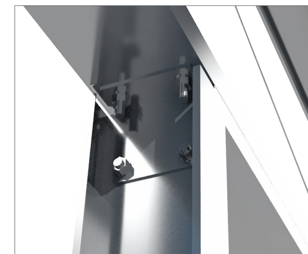
Obr. 131 – provedení přípoje dvou C profilů pomocí spojovacího úhelníku TC
