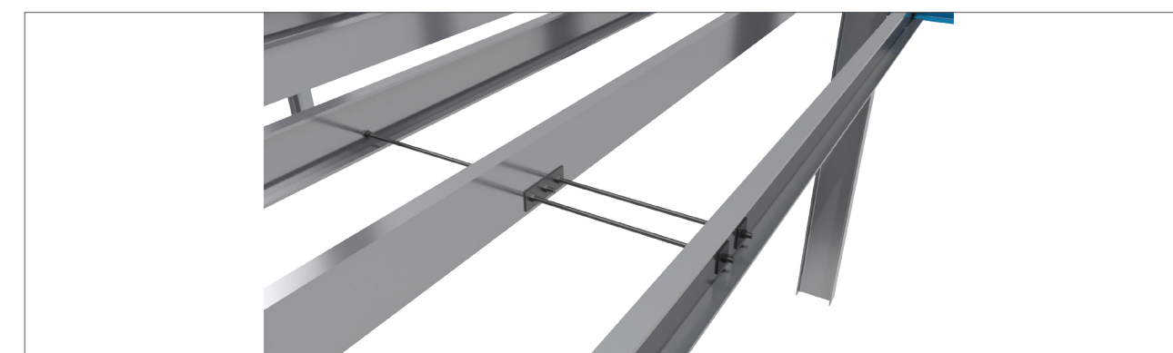
Obr. 157 – Provedení táhla v případě lichého počtu stropnic u konstrukce těžkého stropu
