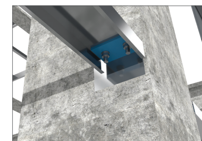
Obr. 122 – Detail připojení ztužující příčné vzpěry k betonovému sloupu. Připoj je proveden pomocí úhelníku a dvojice šroubů M16. Kotevní úhelník je přivařen k ocelové desce umístěné v betonovém sloupu.
