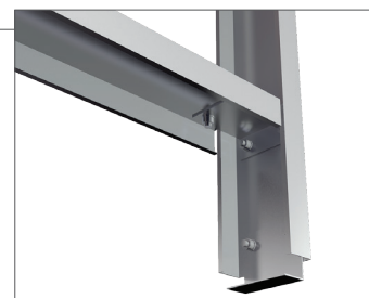
Obr. 100 – Detail napojení paždíku k lemovacímu profilu otvoru okna, popřípadě dveří a připojení lemovacího profilu k podlaze pomocí připojovacího úhelníku. Na tento přípoj lze použít standardní úhelník TC.
