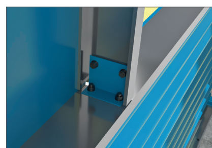
Obr. 110 – Detail spojení prvků výměn. Spoj je proveden jako šroubovaný pomocí spojovacího úhelníku TC. Alternativně mohou být otvory ve svislém prvku provedeny jako zapuštěné, v tomto případě je nutné použít podložku PP.
