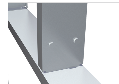
Obr. 103 – Detail provedení lemování okenního otvoru pomocí C profilu stejné výšky jako je profil paždíku. Připojení lemovacího profilu k paždíku je pomocí spojovacího úhelníku (TC). Otvory v lemovacím profilu mohou být provedeny jako standardní nebo zapuštěné. Při použití zapuštěných otvorů je potřeba použít vyrovnávací podložku PP. Při použití nezapuštěných otvorů je potřeba zvětšit velikost otvoru pro okna o hlavy šroubů.
