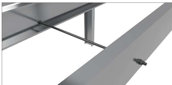
Obr. 152 – Provedení táhla v případě konstrukce lehkého stropu
