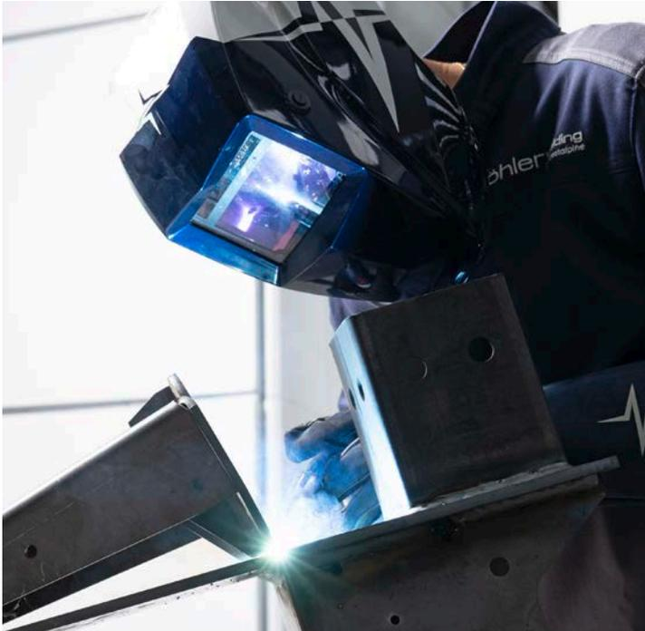
Durch den Lichtbogen beim Schweißen entstehen gefährliche UV und IR Strahlen. Unsere automatischen Schweißerhelme filtern 99.9997% aller UV und IR Strahlen selbst dann, wenn die Filterkassette nicht aktiviert ist.
