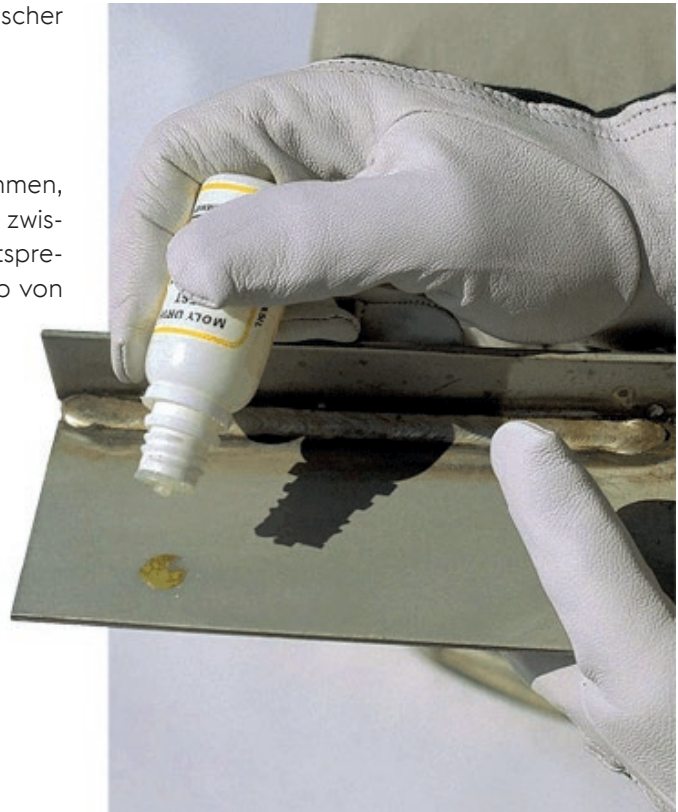
Einfache Bestimmung der Edelstahlgüte mit Avesta Moly-Drop 960.
