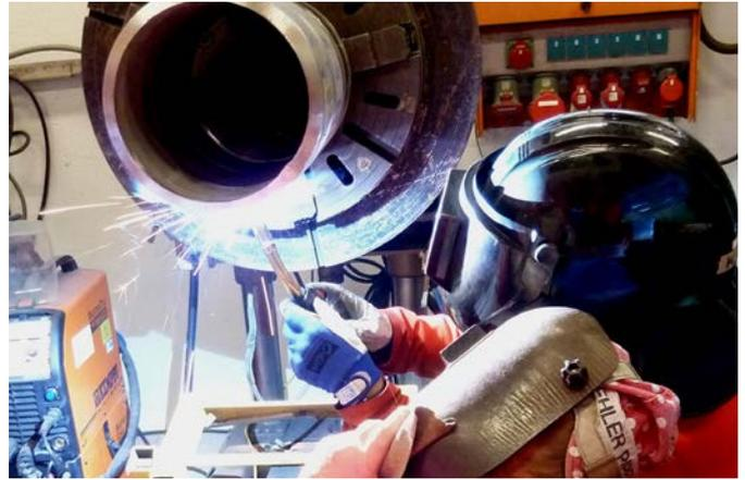
Schweißen eines Rohrs aus Superduplex UNS S32750 mit FOXcore 2594-T1 HD.
