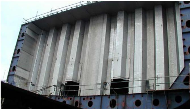
Ladetanks aus 1.4462 in einem Chemikalienschiff, geschweißt mit 100 % CO<sub>2</sub>-Schutzgas. Die Nähte wurden in Wannen- und Horizontalpositionen mit FOXcore 2209-T0 auf einem keramischen Trägermaterial für die Wurzellage geschweißt. FOXcore 2209-T1 wird für das Schweißen in Zwangslage verwendet. FOXcore 309L-T0 DG und FOXcore 309L-T1 finden bei artfremden Schweißungen Anwendung.
