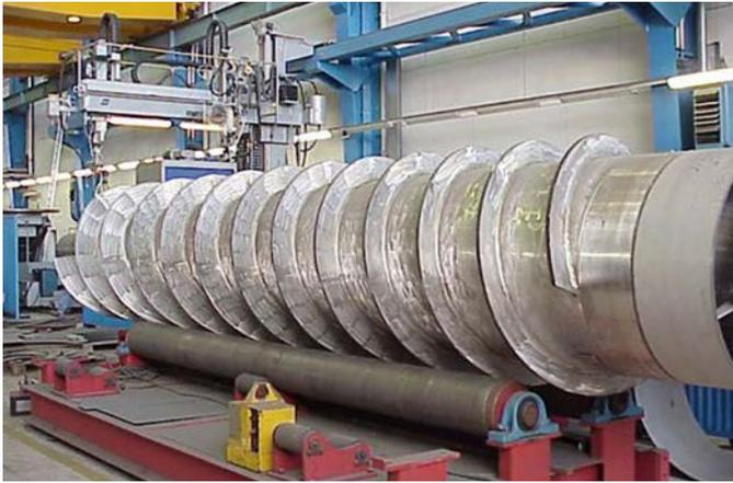
Schneckenwelle aus AISI 316Ti für die Zellstoff- und Papierindustrie, geschweißt mit  $\varnothing$  1,2-mm-Draht FOXcore 316L-T0. Mit freundlicher Genehmigung der Andritz AG aus Österreich.
