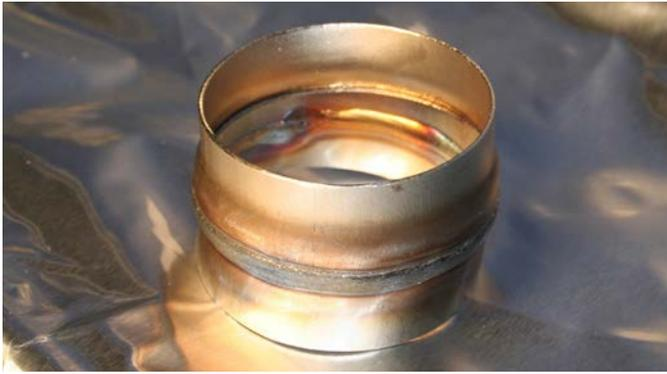
0,6 mm dünner Auspuffkrümmer, geschweißt mit Ø 1,2 mm FOXcore 308L-MC. Bei 2,6 m/min Drahtvorschubgeschwindigkeit, 80–85 A und 20 V lag die Schweißgeschwindigkeit bei 85 cm/min. Für diese Anwendung konnte kein Massivdraht verwendet werden.
