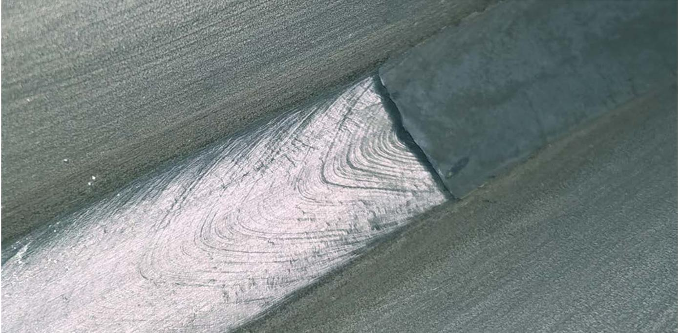
Beim Fülldrahtelektrodenschweißen wird das Schweißbad sowohl durch die Schlacke als auch das Schutzgas geschützt. Die Schlacke bedeckt die Oberfläche des Schweißbads und auch die Rückseite der Wurzel. Dadurch eignet sich das Verfahren besonders gut für einseitiges Schweißen in Aussenbereichen und auf der Baustelle. Bei dem am weitesten verbreiteten Rutil-schlackesystem werden zwei Schlackentypen verwendet: schnell und langsam erstarrende Schlacke.
