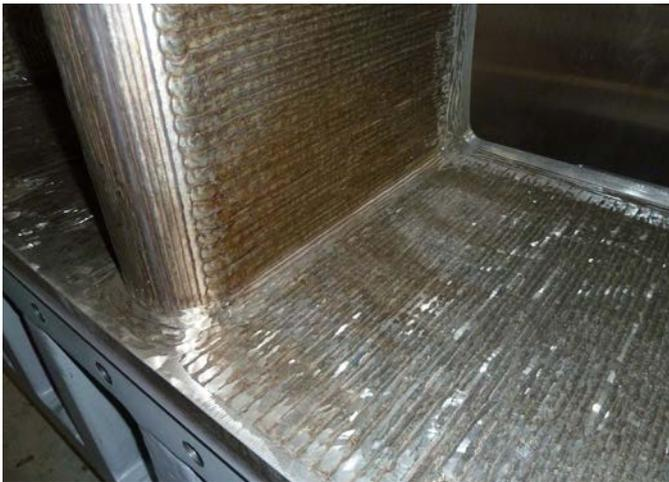
Plattieren mit FOXcore 309L-T1 zum Erhalt einer hochwertigen Oberfläche – auch beim Schweißen in Zwangslage.
