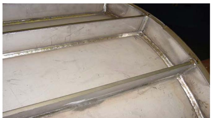
Es werden glatte und glänzende Kehlnähte produziert. In dieser Anwendung wird die Welle eines Scheibenfilters für eine Zellstoff- und Papierfabrik geschweißt. Der Grundwerkstoff ist AISI 316Ti und der verwendete Draht ein FOXcore 316L-T0.
