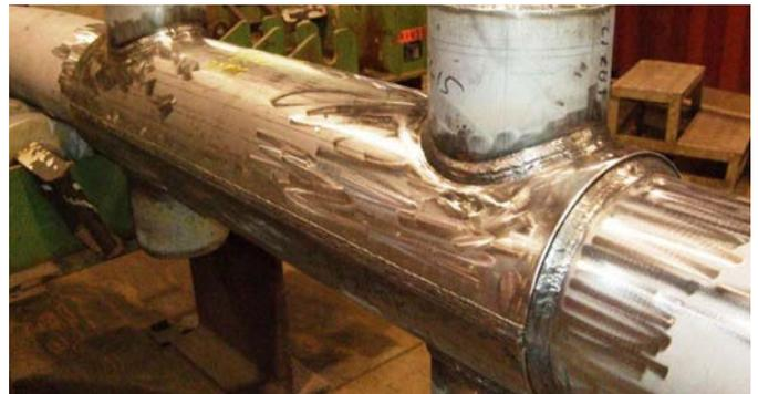
Steigrohre für die Wassereinspritzung in den Beinen einer Offshore-Plattform. Schweißen von Superduplex mit FOXcore 2594-T1 HD.
