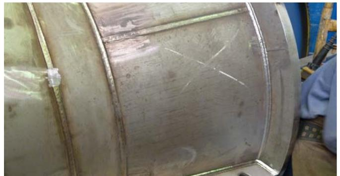
Seewasserpumpen aus Duplex-Edelstahl 1.4462, geschweißt mit FOXcore 2594-T1 um die höchstmögliche Korrosionsbeständigkeit zu erreichen.
