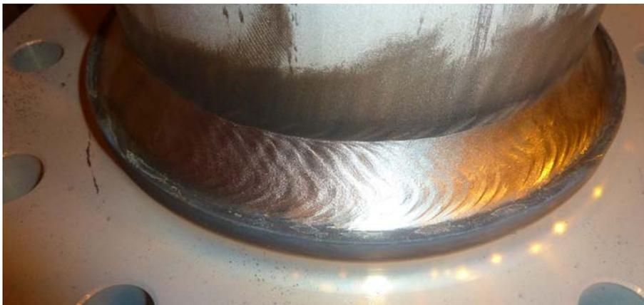
Kehlnaht in Horizontalposition (PB/2F): Der Grundwerkstoff ist AISI 304L und der Zusatz FOXcore 308L-T0 DG mit  $\varnothing$  1,2 mm.
