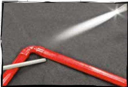
**Löten** ist ein thermisches Verfahren zum stoffschlüssigen Fügen von verschiedensten Werkstoffen, wobei eine flüssige Phase durch Schmelzen eines Lotes oder durch Diffusion an den Grenzflächen (Diffusionslöten) entsteht. Die Solidustemperatur der Grundwerkstoffe wird nicht erreicht; anders als beim Schweißen. Als Hartlöten bezeichnet man Lötverfahren, bei denen die Arbeitstemperatur des Lotes über 450 °C liegt. Bei einer Temperatur darunter spricht man von Weichlöten.
