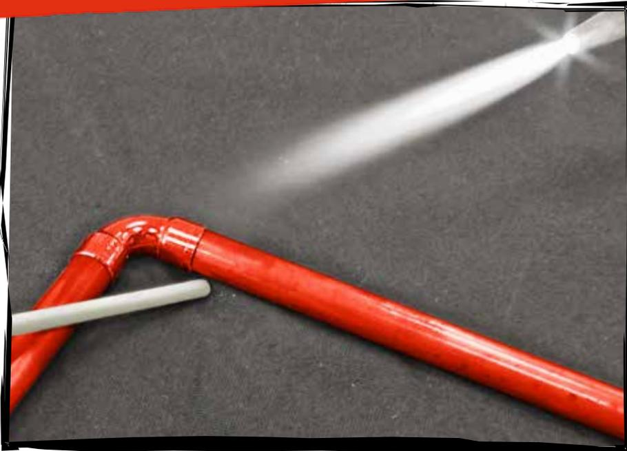
Die Reinigung des Bauteiles vor dem Löten
