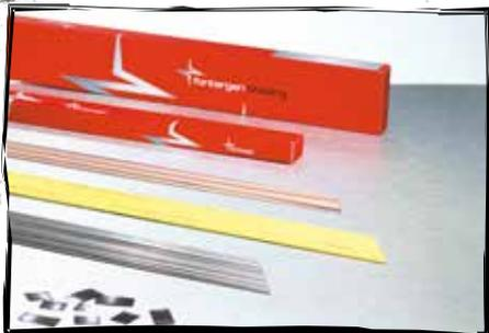
**Lote** Sie stellen die Verbindung der Grundwerkstoffe her und bestehen aus leicht schmelzbaren Legierungen (z.B. Silber Kupfer Zink Zinn / L-Ag55Sn) oder reinem Metall (z.B. Kupfer). Schmelzbereich: Beginn des Schmelzens (Solidustemperatur  $T_s$ ) bis zur vollständigen Verflüssigung (Liquidustemperatur  $T_l$ ). Arbeitstemperatur  $T_A$ : niedrigste Oberflächentemperatur, bei der das Lot die Grundwerkstoff-Fügeflächen benetzt.
