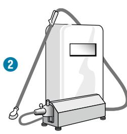
2. Zum Sprühen verwenden Sie eine säurebeständige Pumpe, z. B. Avesta Membrane Pump SP-25.
