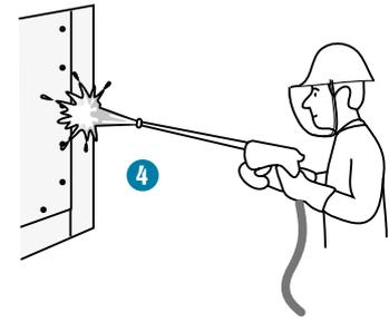
4. Spülen Sie anschließend gründlich mit einem Hochdruckreiniger. Behandeln Sie das Abwasser vor dem Ableiten in die Kanalisation.
