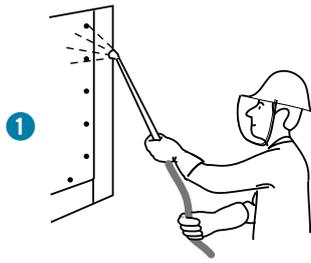
1. Tragen Sie den Reiniger mit einem Pinsel, durch Sprühen oder Tauchen auf.
