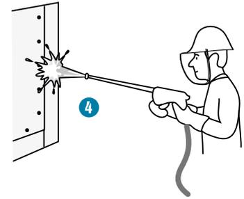
4. Beizrückstände entfernt man mittels Hochdruckreiniger oder mit einer rostfreien Drahtbürste und spült anschließend reichlich mit Wasser. Abwässer sollten vor dem Ableiten behandelt werden.
