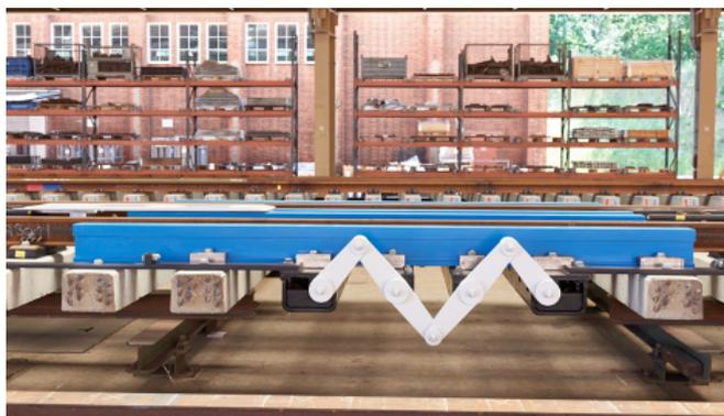
Hilfsbrücke mit Scherensystem
