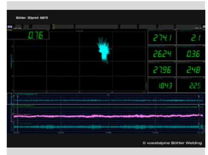
Darstellung von U[V]/I[A] als Funktion der Schweißzeit (blauer Stern in der Mitte) eines 3Dprint AM Drahts der einen stabilen Prozess mit nur geringen Abweichungen aufzeigt.
