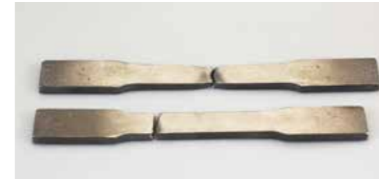
Gedruckter Testkörper und zerstörende Prüfungen eines martensitischen, ausscheidungshärtenden rostfreien Stahls gedruckt mit 3Dprint AM 17-4 PH
