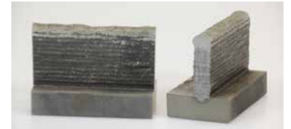
Gedruckter Testkörper und zerstörende Prüfungen eines martensitischen, ausscheidungshärtenden rostfreien Stahls gedruckt mit 3Dprint AM 17-4 PH
