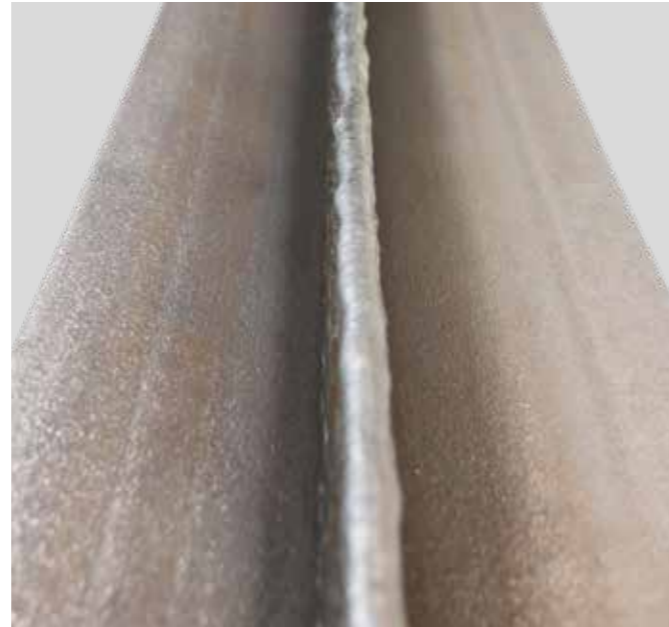
Eine zur Eigenschaftsbestimmung mit dem Draht 3Dprint AM 80HD gefertigte Wand
