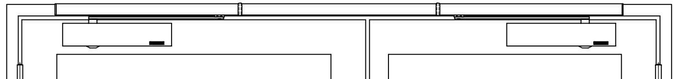
Normalmontage - Bandseite Standard fixing - hinge side
