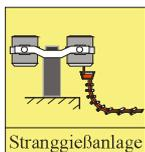
Der nach der sekundärmetallurgischen Behandlung fertig gestellte flüssige Rohstahl wird den Erfordernissen entsprechend in den nachgeschalteten Stranggießanlagen zu Vorblöcken oder Knüppeln vergossen.
