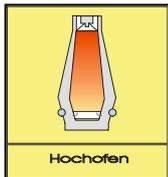
Der Hochofen ist ein Schachtofen, dessen Profil so gestaltet ist, dass ein regelmäßiges Niedergehen der Beschickung und eine gleichmäßige Verteilung der aufsteigenden Gase über den gesamten kreisförmigen Ofenquerschnitt gewährleistet ist. Im Hochofenprozess wird flüssiges Roheisen als Vorprodukt für die Stahlerzeugung hergestellt.
