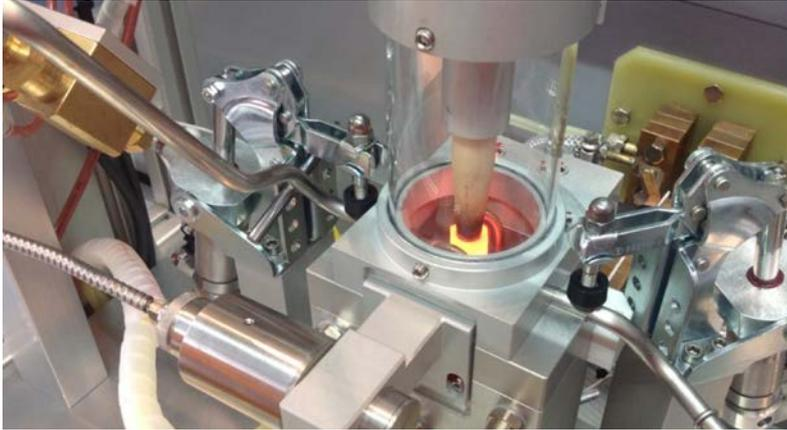
**Schutzgas-Induktionslöten eines Stahlbauteiles mit A 200 L (mit freundlicher Genehmigung durch IEW Induktive Erwärmungsanlagen)**
