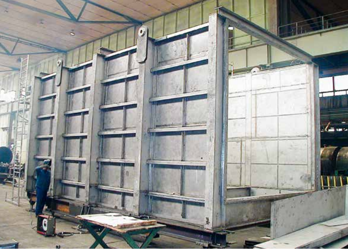
Typisches Objekt aus rostfreiem Stahl, fertig zum Sprühbeizen.
