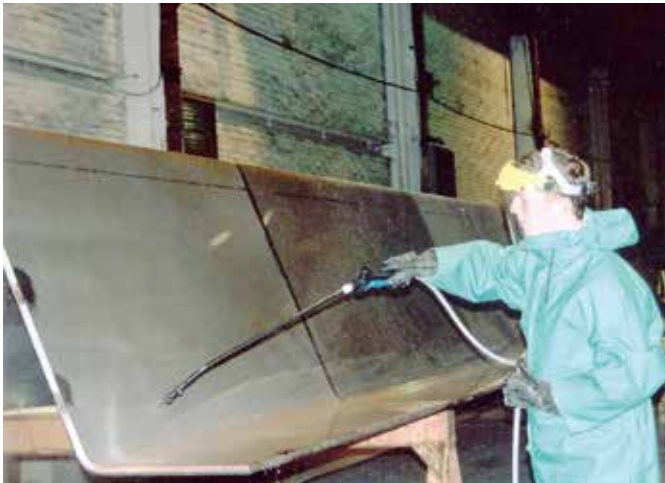
Passivierung eines Schotts für einen Chemikalien-tanker aus rostfreiem Duplex-Stahl
